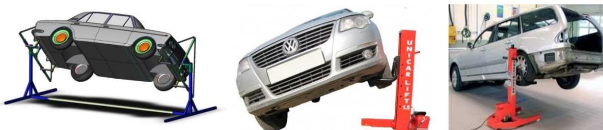
**Рисунок 3 – Опрокидыватели для автомобилей**
