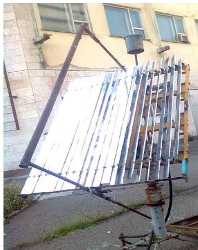
2-rasm: Yassi Fresnel chiziqli oynali quyosh konsentratori: a) sxemasi b) modeli
